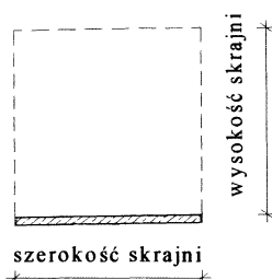
Rys. 17. Schemat skrajni chodnika na obiekcie mostowym.
