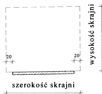
Rys. 18. Schemat skrajni ścieżki rowerowej na obiekcie mostowym.
